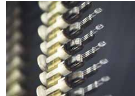
Clip-System ermöglicht die einfache Montage der Aufnahmen am Transportriemen
